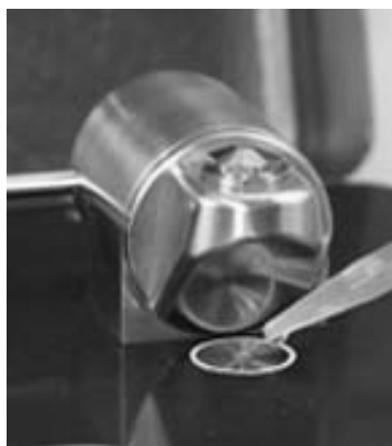
図6：サンプルをTumbIRの下ウィンドウに適用する
