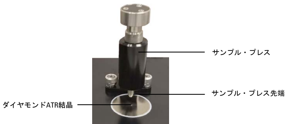
図7：サンプル・プレスを最高の位置まで上げて、サンプルのロードとクリーニングをやりやすくする
