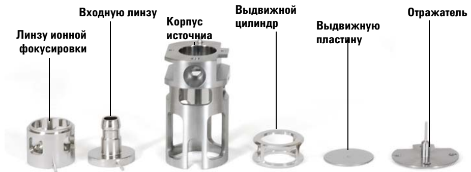
Рис. 29 Детали ионного источника ХИ, требующие чистки
