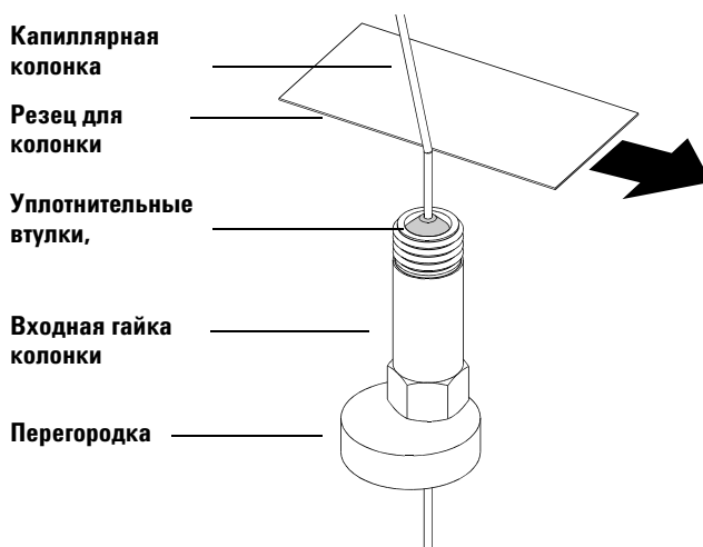
Рис. 2 Подготовка капиллярной колонки к установке
