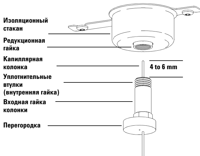
Рис. 3 Установка капиллярной колонки в инжектор с делением/без деления потока
