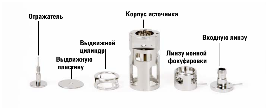
Рис. 24 Детали стандартного источника, подвергаемые чистке
