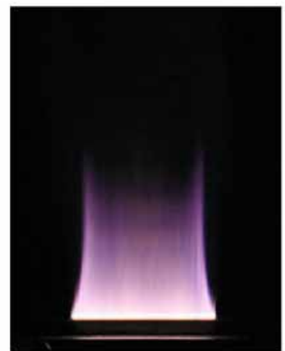
Fett Erhöhung des Acetylen-Flusses
