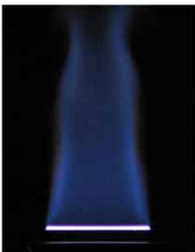
Mager Reduzierung des Acetylen-Flusses
