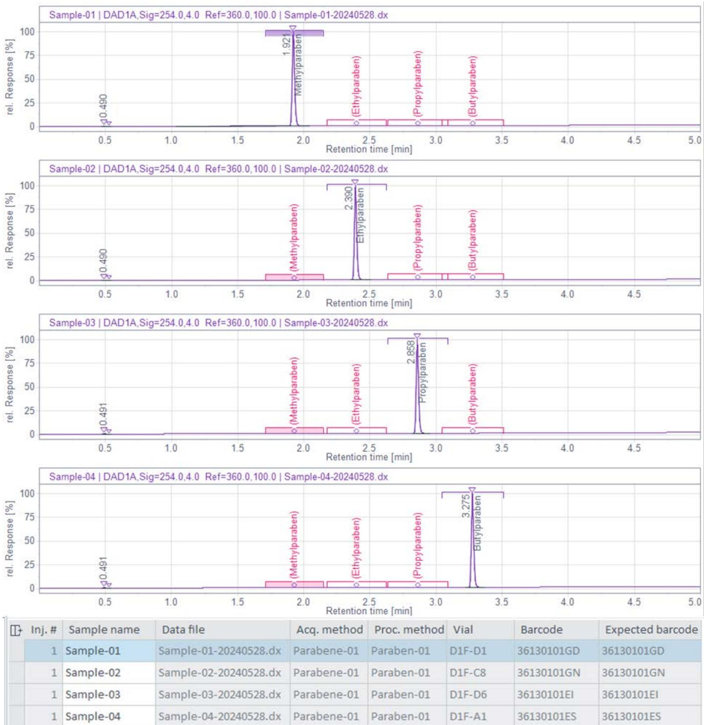
图 2. 通过预期条形码识别随机放置的样品。预期条形码已通过序列列表导入。样品瓶位置在 Multisampler 确认条形码后得到了指定 (样品瓶标签示例: D1F-D1: 抽屉 1 前部, 位置 D1)
