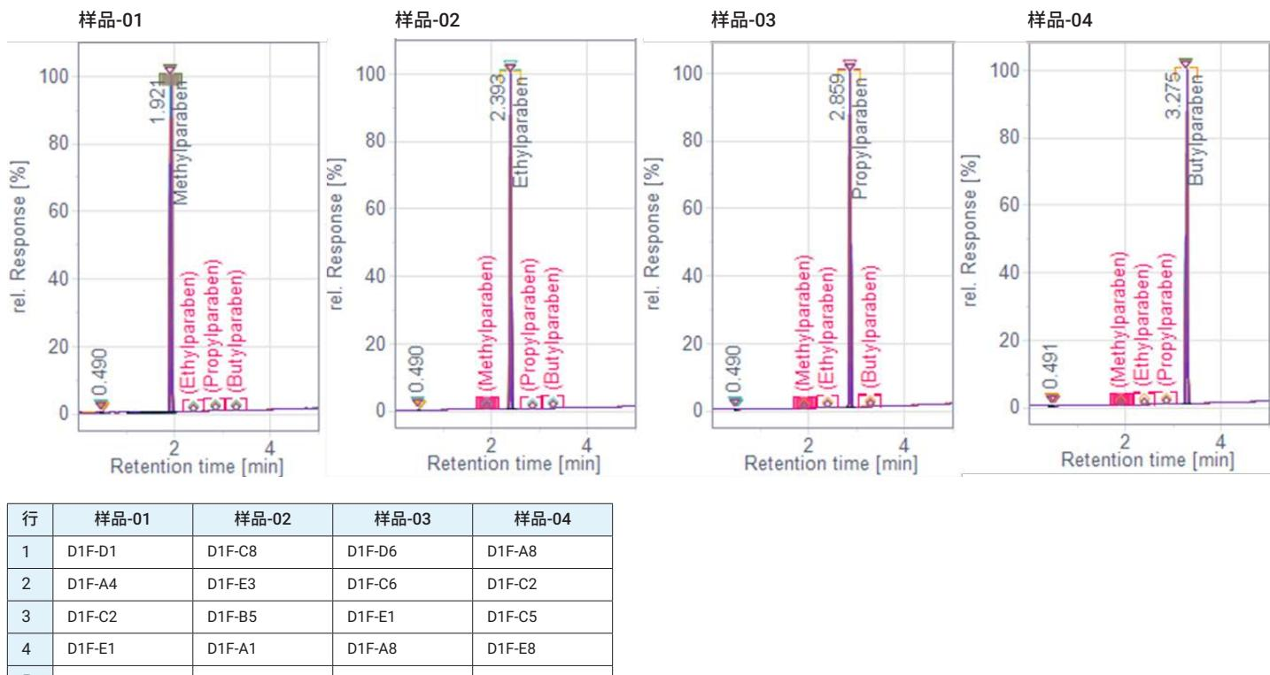
图 3. 随机放置样品的识别，包括使用多个抽屉（D1、D2 = 抽屉 1 和抽屉 2，F、B = 前部、后部）。色谱图显示了相应样品的叠加结果
