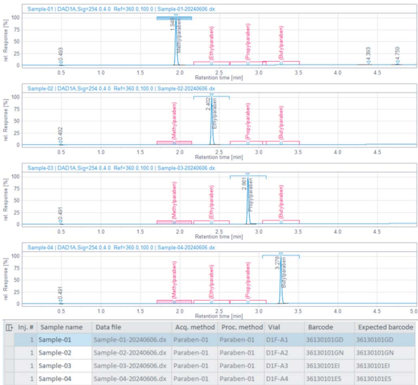
图 2. 序列运行后的数据分析结果。进样列表显示预期条形码，以及各自的样品瓶位置，以便与匹配的条形码进行确认。色谱图显示了预期化合物
