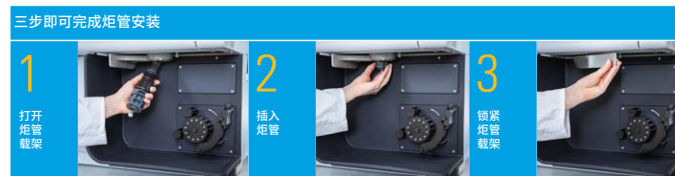
图 2. 只需三步即可将炬管安装到仪器上，从而实现快速启动并获得良好的重复性
