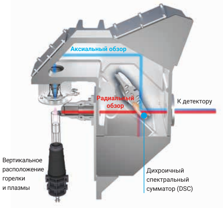
Рис. 1. Схема хода лучей при радиальном и аксиальном обзоре, одновременно сходящихся в DSC. Объединенные лучи затем передаются на полихроматор и детектор.
