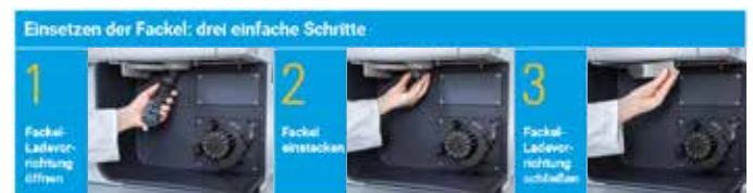
Abbildung 2. Sequenz von drei einfachen Schritten zum Laden der Fackel in das Gerät für einen schnellen Start und reproduzierbare Leistung.
