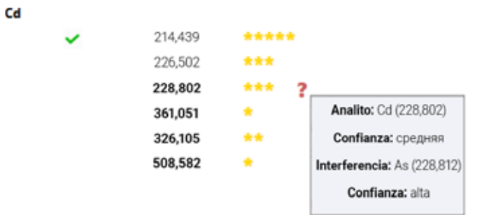
Figura 2. IntelliQuant indica la mejor longitud de onda del analito con una clasificación de muchas estrellas y una marca de verificación verde. También destaca las interferencias sospechadas sobre las longitudes de onda del analito usando una clasificación de pocas estrellas. Las potenciales superposiciones espectrales se pueden identificar colocando el cursor sobre el signo de interrogación rojo.
