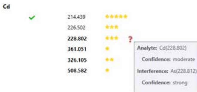
Figura 2. IntelliQuant indica la mejor longitud de onda del analito con una clasificación de muchas estrellas y una marca de verificación verde. También destaca las interferencias sospechadas sobre las longitudes de onda del analito usando una clasificación de pocas estrellas. Las potenciales superposiciones espectrales se pueden identificar colocando el cursor sobre el signo de interrogación rojo.
