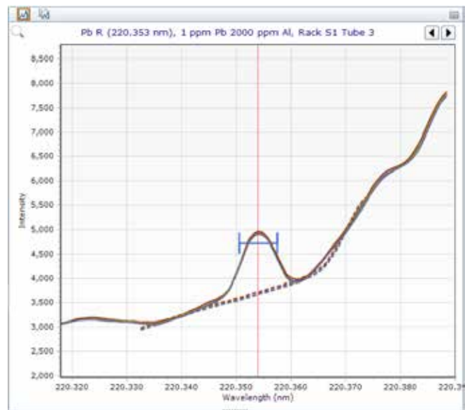
Figura 2b. Linea di emissione del Pb a 220,353 nm in 2000 mg/L di alluminio. La sovrapposizione laterale dalla linea allargata dello spettro dell'Al a 220,467 nm ha determinato un segnale del fondo più elevato e dal profilo curvo per il Pb a 220,353 nm, un fenomeno che viene corretto adeguatamente dalla tecnica FBC.
