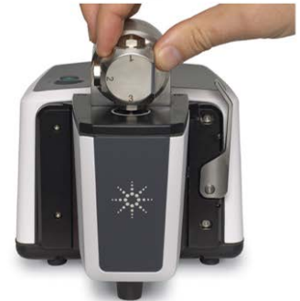
그림 2. 액체 시료 분석. DialPath 액세서를 이용한 3단계 분석.
