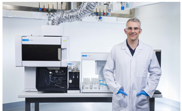
图 10. ICP 自动化系统包括仪器、自动进样器、AVS 切换阀和 ADS 2 自动稀释器
