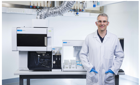
그림 10. ICP 자동화 시스템은 기기, 자동 시료 주입기, AVS 스위칭 밸브 및 ADS 2 자동 희석기로 구성됩니다.
