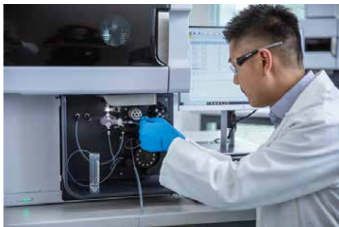
Figura 5. Un accessorio AVS 7 integrato al sistema di introduzione del campione di un ICP-OES Agilent 5900.
