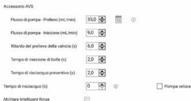
Figura 4. Il semplice software che controlla l'accessorio AVS.
