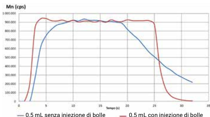
Figura 3. Tempo di misurazione disponibile per un loop di campionamento da 0,5 mL con un tempo di misurazione di 19 secondi con iniezione di bolle, rispetto ai 9 secondi senza iniezione.
