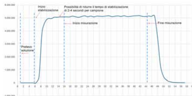
Figura 11. In questa schermata del timing monitor, il segnale Mn si stabilizza a 12 secondi, ma la misurazione inizia a 16 secondi. La misurazione potrebbe iniziare a 12 secondi, consentendo di risparmiare fino a 4 secondi per campione.
