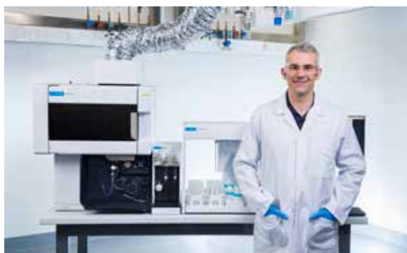
Figure 10. Le système d'automatisation ICP comprend l'instrument, un passeur automatique d'échantillons, la vanne de commutation AVS et l'autodiluteur ADS 2.
