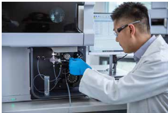
Figura 5. Un accesorio AVS 7, integrado con el sistema de introducción de muestras de un sistema de ICP-OES Agilent 5900.
