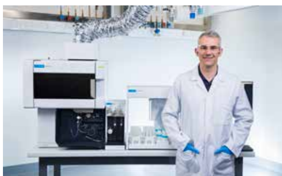
Figura 10. El sistema de automatización de ICP comprende el instrumento, un automuestreador, la válvula de conmutación AVS y el diluidor automático ADS 2.
