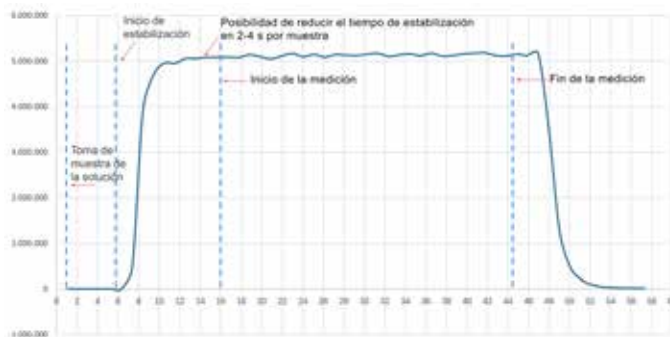
Figura 11. En esta pantalla del monitor de tiempo, la señal Mn se estabiliza a los 12 segundos, pero la medición comienza a los 16 segundos. La medición podría comenzar a los 12 segundos, ahorrando hasta 4 segundos por muestra.
