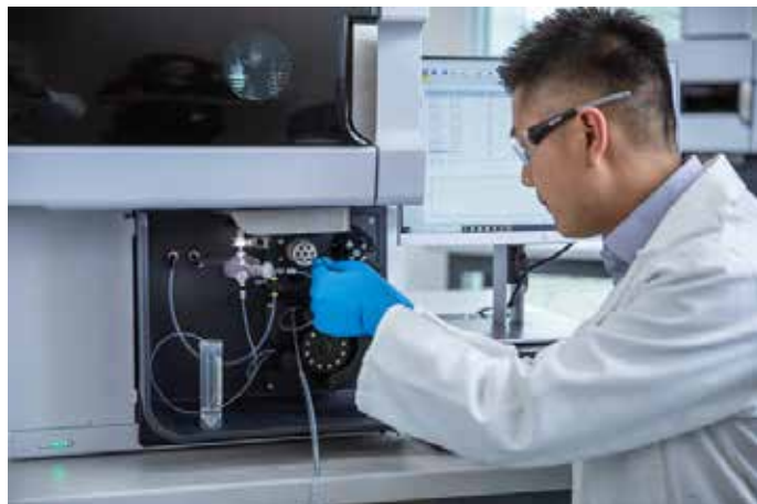
Abbildung 5. Ein Schaltventil AVS 7, das in das Probenaufgabesystem eines Agilent 5900 ICP-OES integriert ist.
