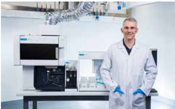
Abbildung 10. Das ICP-Automatonsystem umfasst das Gerät, einen automatischen Probengeber, das Schaltventil AVS und das automatische Verdünnungssystem ADS 2.
