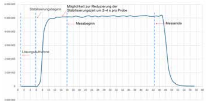
Abbildung 11. In dieser Anzeige des Timing-Monitors stabilisiert sich das Mn-Signal bei 12 Sekunden, die Messung beginnt jedoch bei 16 Sekunden. Die Messung könnte bei 12 Sekunden starten, was 4 Sekunden pro Probe spart.
