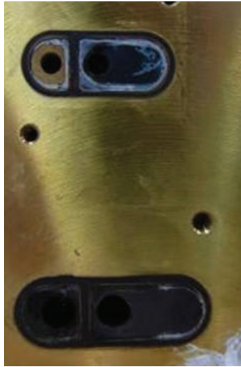
Figura 1. Serie di immagini di un collettore dell'acqua di raffreddamento che mostrano l'accumulo di depositi di prodotti di corrosione dopo diversi mesi di funzionamento, utilizzando differenti tipi di acqua nel circuito di raffreddamento.
