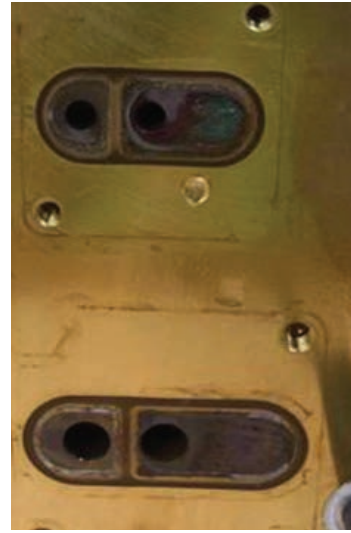
Après 2 mois d'utilisation avec un liquide de refroidissement non optimisé, dépourvu d'inhibiteur de corrosion, la corrosion des surfaces internes peut être facilement identifiée par les zones sombres.
