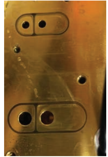
Après 3,5 mois d'utilisation avec le liquide de refroidissement Agilent Cool Clear optimisé, contenant un inhibiteur de corrosion, les surfaces internes restent impeccables, ce qui confirme une protection supérieure contre la corrosion.
