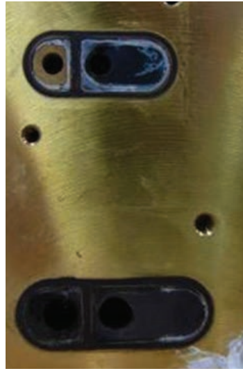
Après 4 mois d'utilisation avec de l'eau déionisée, la corrosion des surfaces internes peut être facilement identifiée par les zones sombres. La dégradation observée est bien pire que dans le cas d'un liquide de refroidissement non optimisé.
