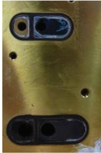
Abbildung 1. Eine Reihe von Bildern eines Kühlwasserverteilers, die die Ansammlung von Korrosionsablagerungen nach mehrmonatigem Betrieb mit verschiedenen Wassertypen im Kühlkreislauf veranschaulichen.
