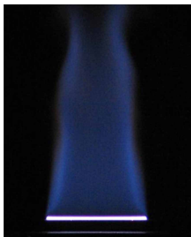
低すぎる状態 アセチレン流量を減らす必要がある
