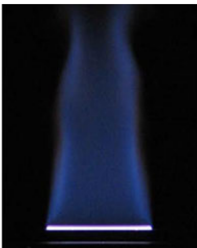
Mager Reduzierter Acetylenfluss
