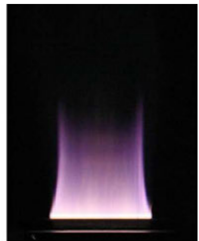
Fett Erhöhter Acetylenfluss
