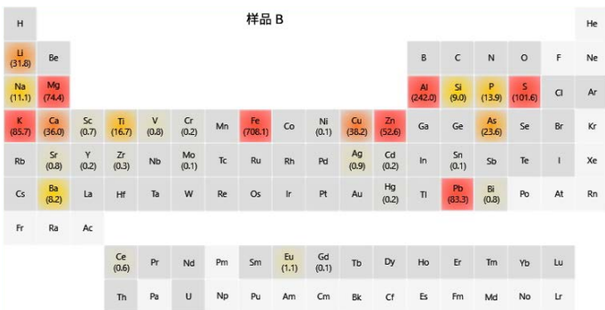
图 4. IntelliQuant 生成的热点图直观地显示了样品中所含元素的相对浓度。该信息提供了针对样品的有用的分析见解，有助于方法开发
