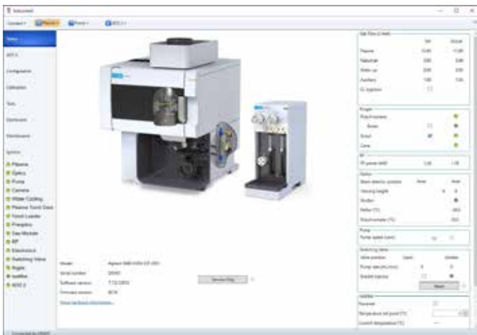
Figura 17. Accedendo alla pagina interattiva Instrument Status è possibile controllare lo stato corrente dello strumento e individuare le cause dei problemi.
