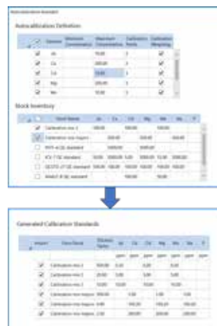
Figura 11. L'assistente alla calibrazione automatica è in grado di preparare standard da una specifica soluzione stock.
