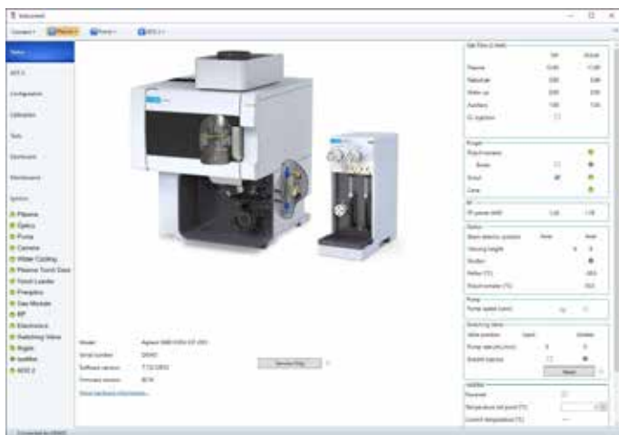
Figura 17. Consulte la página interactiva de estado del instrumento para verificar el estado actual del instrumento e identificar causas de problemas.
