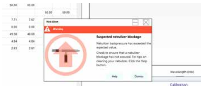
Figura 9. Neb Alert envía una notificación instantánea al usuario si se detecta una potencial obstrucción o bloqueo del nebulizador.
