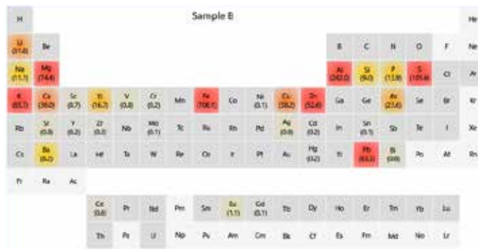
Abbildung 5. IntelliQuant erzeugt eine Heat Map zur visuellen Darstellung der relativen Konzentrationen der in einer Probe vorhandenen Elemente. Die Informationen liefern analytische Erkenntnisse über die Probe, die für die Methodenentwicklung hilfreich sind.
