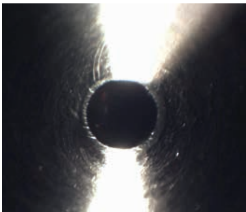
Figura 13. Fotomicrografia do cone de amostragem fabricado pelo Concorrente I (número de série 74537). Possui acabamento áspero com arranhões notáveis.
