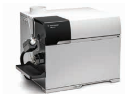
Figura 5. Um sistema ICP-MS de quadrupolo simples Agilent 7900 foi usado para testes de desempenho dos cones de amostragem e skimmer.
