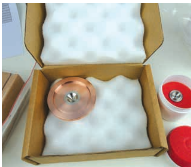
Figura 9. O cone de amostragem fica solto no enchimento de espuma da embalagem de papelão usada pelos Concorrentes I e S, o que significa que o cone pode ser danificado com manuseio brusco.
