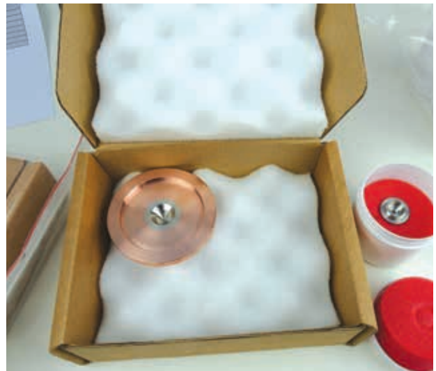
Figura 9. Il cono di campionamento è imballato con ampia possibilità di movimento nell'inserto in schiuma del pacchetto in cartone dei concorrenti I ed S, il che significa che il cono può riportare danni in caso di manipolazione poco attenta.
