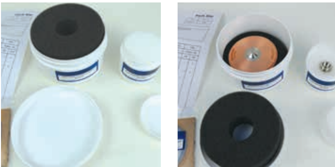
Figura 8. Imballaggio utilizzato per i coni di campionamento (in basso a sinistra) e per skimmer (in basso a destra) del concorrente E, basato su un contenitore cilindrico in plastica.
