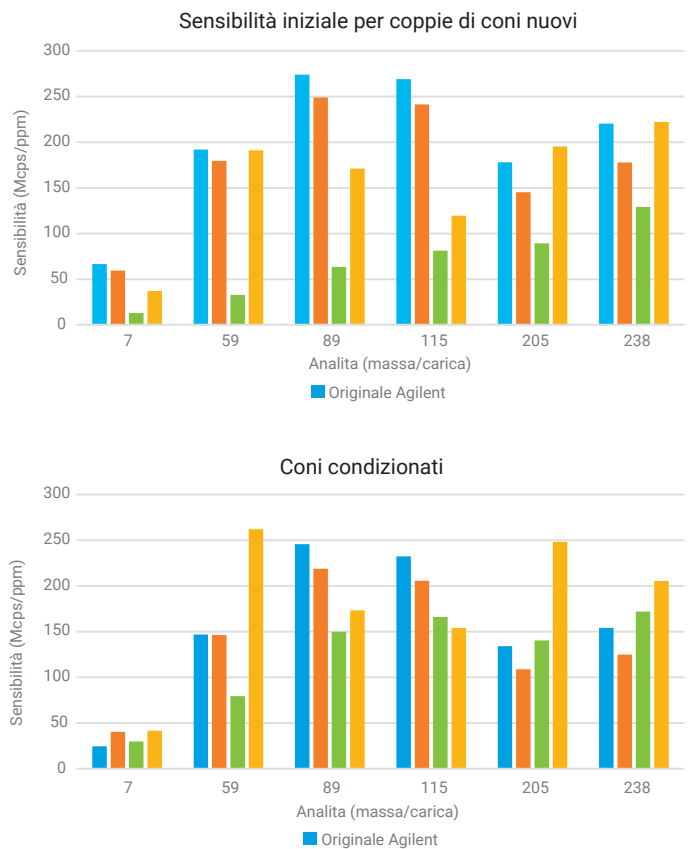
Figura 14. Confronto di sensibilità del sistema ICP-MS 7900 testato con le coppie cono di campionamento-cono per skimmer di ognuno dei produttori.
