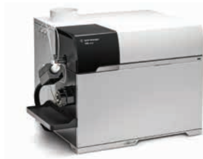
Figura 5. Per i test delle prestazioni dei coni di campionamento e per skimmer è stato utilizzato un sistema ICP-MS a singolo quadrupolo Agilent 7900.
