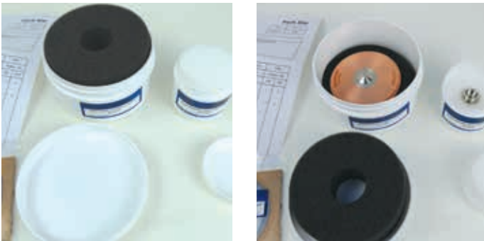
Figure 8. Emballage constitué d'une boîte cylindrique en plastique utilisé pour les cônes échantillonneurs (en bas à gauche) et les cônes écrêteurs (en bas à droite) du concurrent E.
