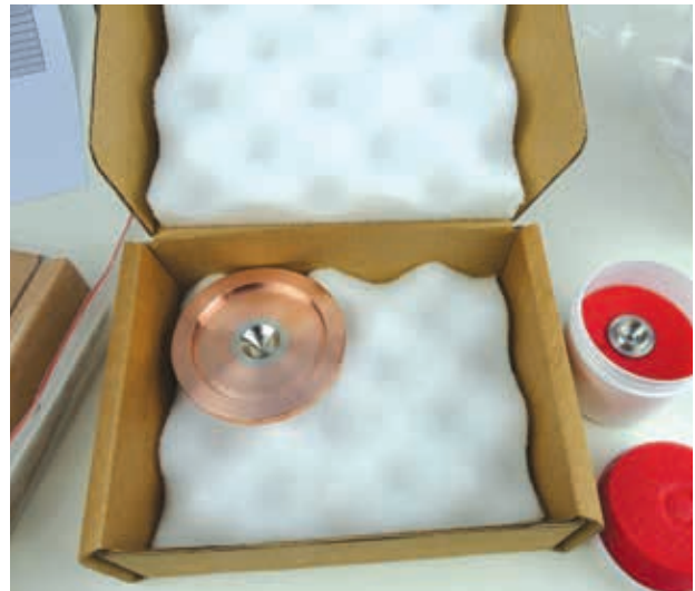
Figure 9. Le cône échantillonneur des concurrents I et S est emballé sans fixation dans un insert en mousse à l'intérieur d'une boîte en carton, ce qui implique que le cône peut être endommagé lors des manipulations brusques.
