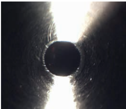
Figure 13. Photomicrographie du cône échantillonneur fabriqué par le concurrent I (numéro de série 74537). Il présente une finition grossière avec des rayures visibles.
