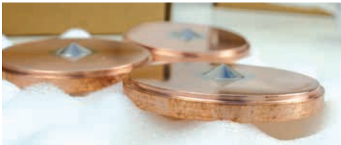
Figure 10. Dommages causés par l'humidité sur des cônes échantillonneurs du concurrent I.
