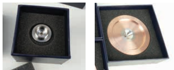
Figure 7. L'emballage utilisé pour les cônes échantillonneurs (en bas à droite) et les cônes écrêteurs (en bas à gauche) du concurrent G fournit une protection similaire pendant le transport.
