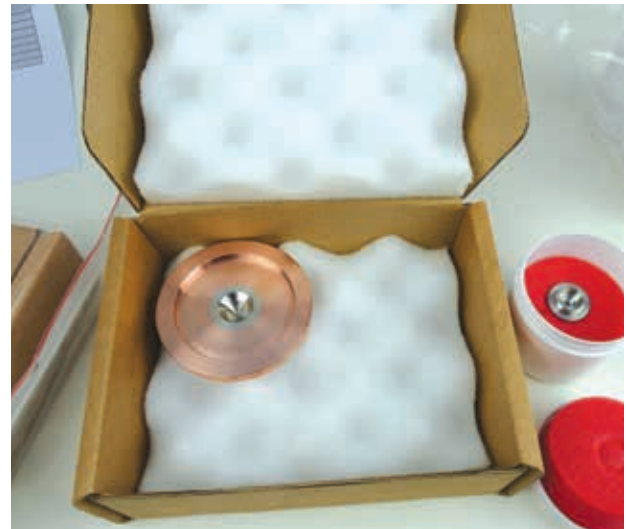
Figura 9. Cono de muestreo introducido sin quedar fijo en la pieza de espuma de la caja de cartón de los proveedores I y S. El cono se puede dañar si el paquete no se manipula cuidadosamente.
