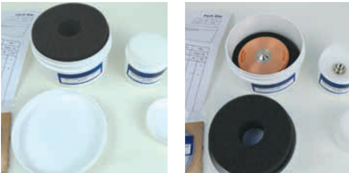
Figura 8. Empaquetado utilizado para los conos de muestreo (abajo a la izquierda) y skimmer (abajo a la derecha) del proveedor E: contenedores cilíndricos de plástico.
