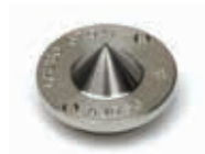
Figura 2. Cono skimmer de Ni genuino de Agilent.
