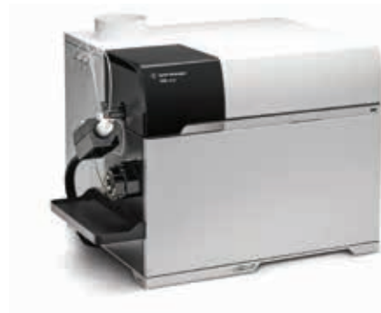
Abb. 5. Für die Leistungsprüfungen der Proben- und Skimmer-Konen wurde ein Agilent 7900-Single-Quadrupol-ICP-MS-System verwendet.
