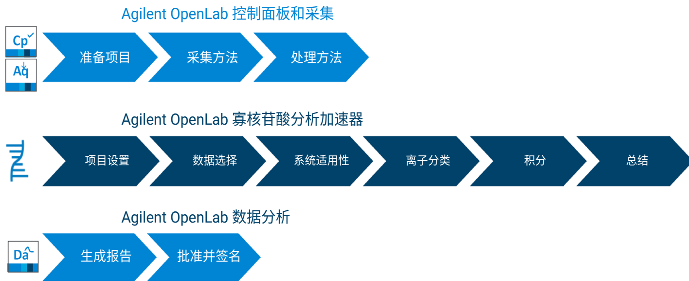
图 4. 使用用于 OpenLab CDS 的安捷伦寡核苷酸分析加速器对寡核苷酸进行纯度、含量和杂质分析的完整分析工作流程。项目配置和数据采集分别在 Agilent OpenLab 控制面板和采集软件中进行。数据分析在安捷伦寡核苷酸分析加速器中进行。报告和批准在 Agilent OpenLab 数据分析软件中进行
