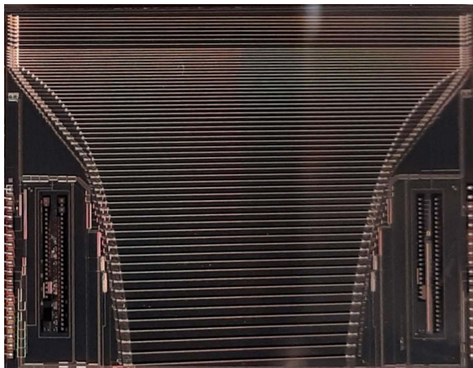
图 4. Vista Chip III 检测器采用 I-MAP 和自适应积分技术，速度更快，并实现对 167-785 nm 的全波长覆盖
