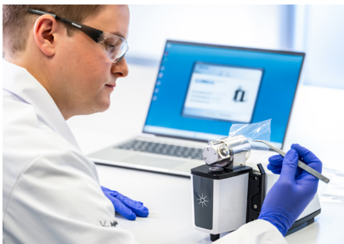
Figura 3. L'accessorio DialPath può essere utilizzato per misurare film polimerici.
