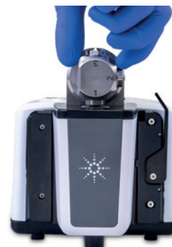
Figura 2. Analisi di campioni liquidi. I tre passaggi dell'analisi con l'accessorio DialPath.
