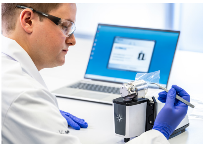
Figure 3. Il est possible d'utiliser l'accessoire DialPath pour mesurer des films polymères.
