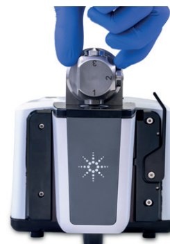
Figure 2. Analyse d'échantillon liquide. Analyse en trois étapes avec l'accessoire DialPath.
