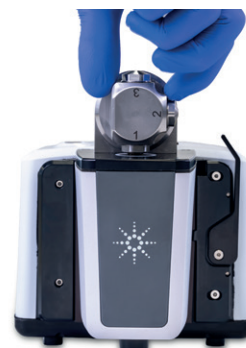
Figura 2. Análisis de muestras líquidas. Tres pasos para realizar análisis con el accesorio DialPath.
