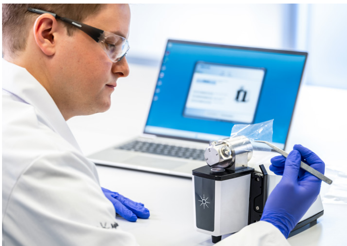
Abbildung 3. Das DialPath-Zubehör kann für die Messung von Polymerfilmen verwendet werden.
