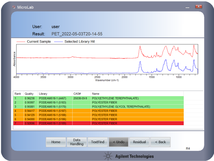
图 10. 配备钻石晶体 ATR 采样附件的 Agilent Cary 630 FTIR 获得的匹配结果采用颜色标记，可以快速清晰地显示。常规的定性原辅料鉴定方法可以自动鉴定聚合物的类型，置信水平较高
