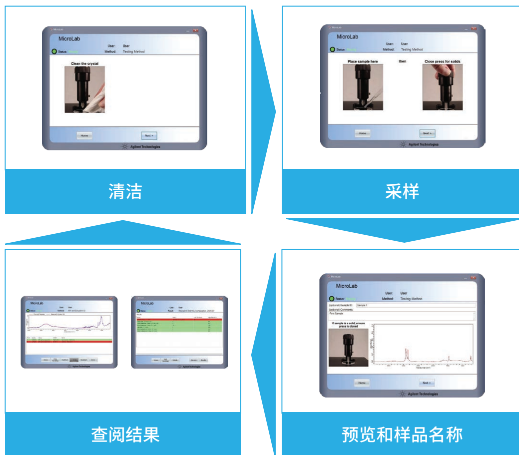
图 5. Agilent MicroLab 软件的图片指导界面简化了使用 Agilent Cary 630 FTIR 的分析，减少了培训需求。软件复制了操作人员使用仪器时看到的内容。完成数据采集后，会采用易于理解的形式直接显示结果，如图 6 和图 10 所示。用户检查完结果后，软件将开始下一个分析，确保分析工作流程的连续性
