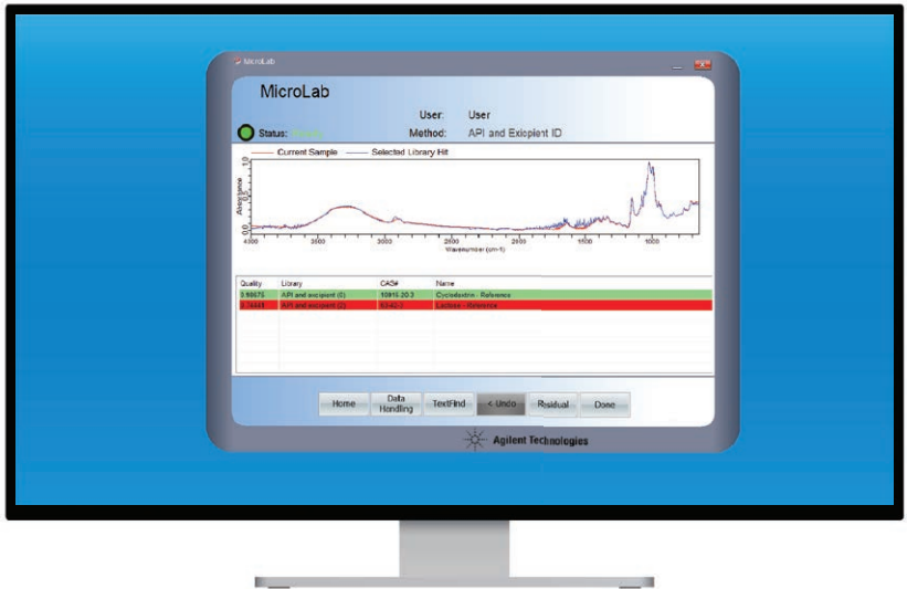
图 9. Agilent MicroLab 软件对谱库检索结果进行颜色标记。颜色标记简化了结果解析，可减少疏忽导致的错误。此截图中，绿色的为 \alpha -环糊精的结果，与谱库光谱匹配度较高
