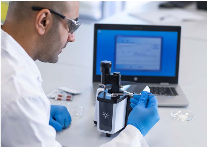
图 1. 配备钻石晶体 ATR 采样附件的 Agilent Cary 630 FTIR 用于鉴定不同粉末的身份
