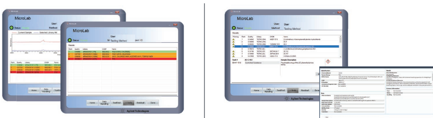
图 6. 在 Agilent MicroLab 软件中，可以采用易于理解的方式显示谱库检索结果，让非专业用户也能查看并解析结果。左图：谱库匹配数据仅以列表形式显示或以列表+谱图的形式显示。右图：此外，可以选择是否显示化学元数据，如危险信息和急救信息
