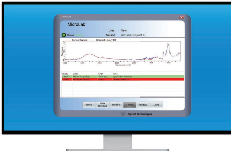
그림 9. Agilent MicroLab 소프트웨어는 라이브러리 검색 결과에 색상 코드를 적용합니다. 색상 코드는 결과 해석을 쉽게 해 주고, 오류로 이어질 수 있는 실수 가능성을 줄여줍니다. 스크린샷은 녹색으로 표시된 \alpha -cyclodextrin 결과이며, 이는 라이브러리 스펙트럼의 우수한 매치율을 나타냅니다.
