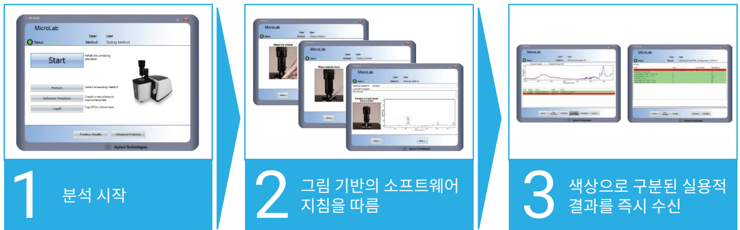
그림 2. Agilent MicroLab 소프트웨어의 직관적인 워크플로는 Agilent Cary 630 FTIR 분광기의 분석 결과에서 쉽게 답을 찾을 수 있도록 해줍니다. 그림을 통해 안내되는 이 소프트웨어는 교육의 필요성을 줄여주고 사용자의 오류 위험을 최소화합니다.
