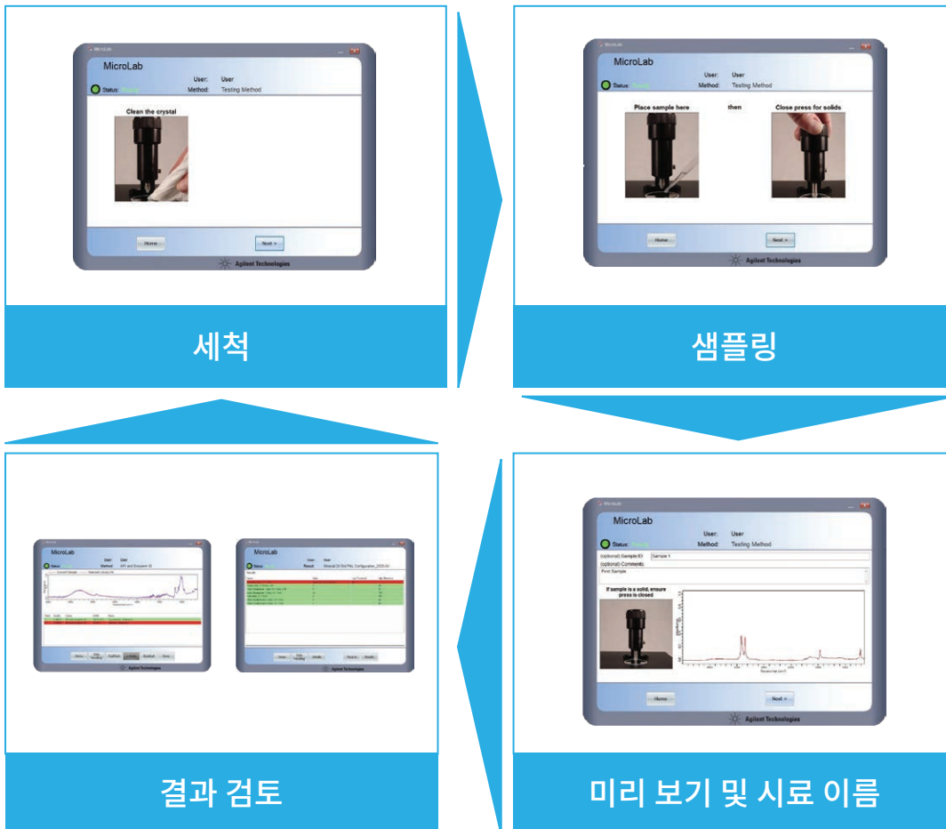
그림 5. Agilent MicroLab 소프트웨어의 영상 안내 인터페이스는 Agilent Cary 630 FTIR를 사용한 분석 과정을 쉽게 해주어, 교육의 필요성을 줄여줍니다. 이 소프트웨어는 작업자가 기기 사용 시 보게 되는 상황을 그대로 보여줍니다. 데이터 수집 후 결과는 그림 6과 그림 10에서처럼 알아보기 쉬운 형태로 직접 표시됩니다. 사용자가 결과를 확인한 후, 소프트웨어는 다음 분석을 시작해 연속적인 분석 워크플로를 보장합니다.
