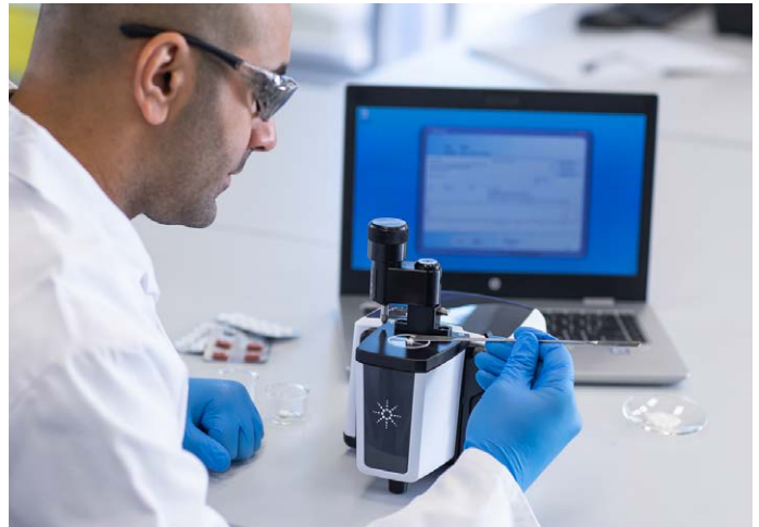
그림 1. 다이아몬드 ATR 샘플링 모듈을 갖춘 Agilent Cary 630 FTIR은 여러 분말의 식별을 위해 사용됩니다.
