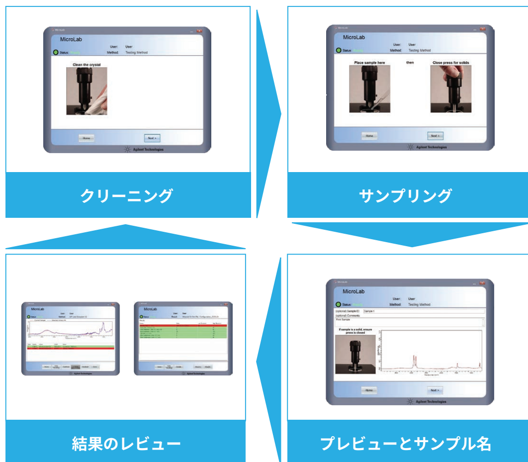
図 5. Agilent MicroLab ソフトウェアの画像ガイダンスインターフェースは、Agilent Cary 630 FTIR を使用した分析の実行を簡素化し、トレーニングの必要性を低減します。ソフトウェアは、機器の使用時にオペレーターが見ているものと同じ画像を表示します。データ取り込みの後、図 6 および 10 で示されるように、結果が分かりやすいフォーマットですぐに表示されます。ユーザーが結果を確認した後、ソフトウェアでは次の分析が開始され、連続的な分析ワークフローが確保されます。
