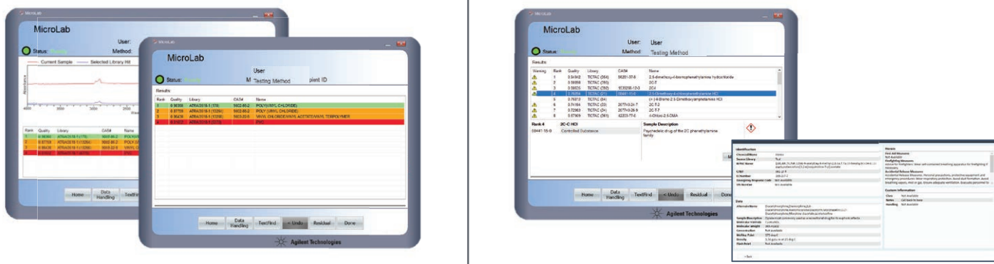
図 6. Agilent MicroLab ソフトウェアは、ライブラリ検索メソッドの結果画面が分かりやすく、経験が浅いユーザーでも確認して結果を解釈できるようになっています。左：ライブラリヒットデータが、リストのみで、またはリストとスペクトルで表示されます。右：危険情報やファーストレスポンス情報を含む化学物質メタデータのオプション画面も利用できます。
