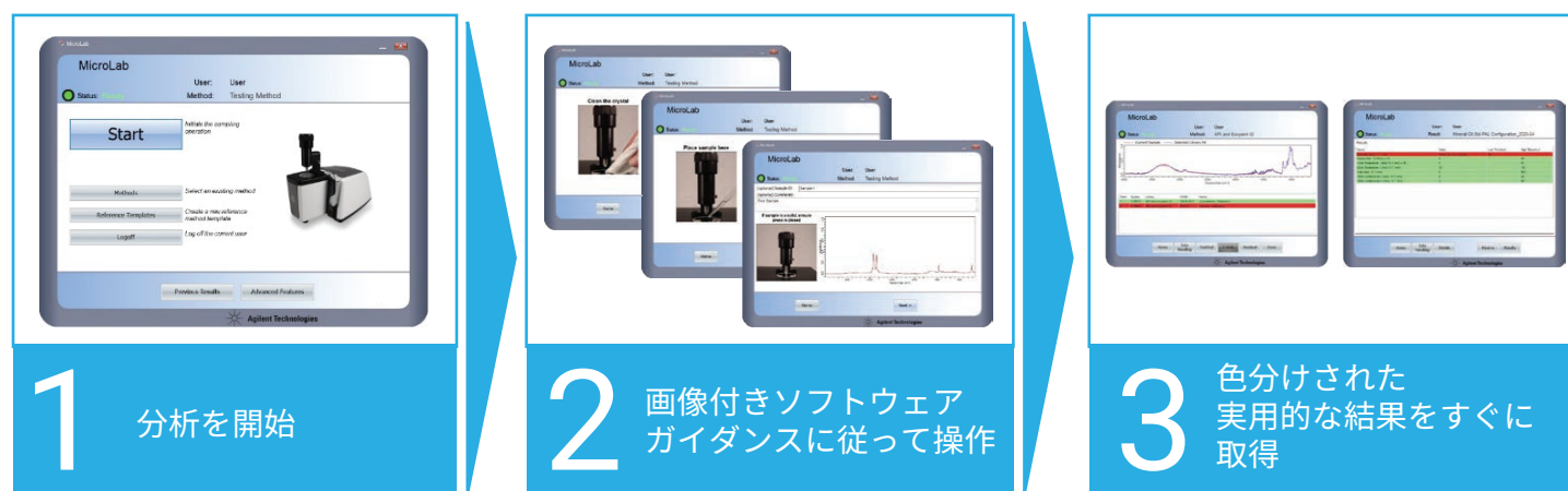
図 2. 直感的な Agilent MicroLab ソフトウェアのワークフローにより、Agilent Cary 630 FTIR 分光光度計を用いて簡単に答えにたどり着くことができます。また、画像ガイド付きソフトウェアは、トレーニングの必要性を低減し、ユーザーのミスリスクを最小に抑えます。
