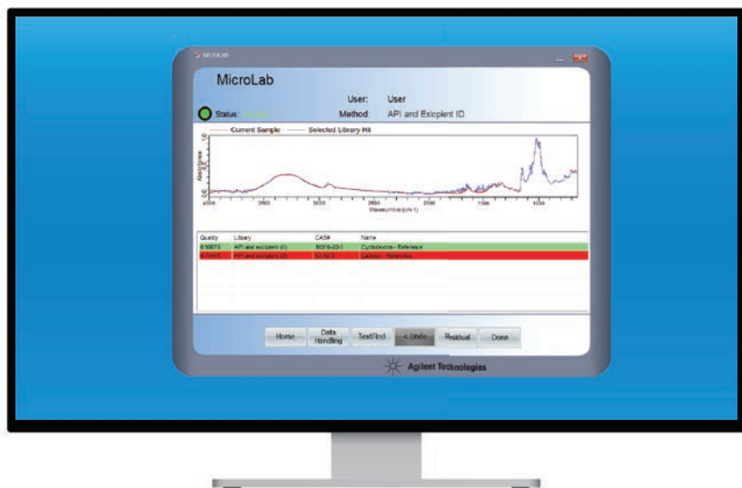
Figura 9. Il software Agilent MicroLab applica codici cromatici ai risultati della ricerca nelle librerie. La codifica cromatica semplifica l'interpretazione dei risultati e riduce le sviste, che potrebbero portare a errori. L'immagine della schermata mostra i risultati per \alpha -ciclodestrina in verde, a indicare che è stata trovata una buona corrispondenza con lo spettro presente nella libreria.
