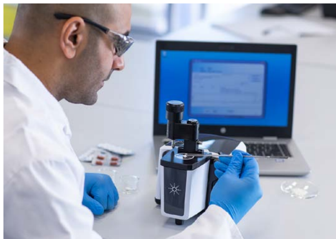
Figura 1. Il sistema FTIR Agilent Cary 630 con modulo di campionamento ATR in diamante viene usato per stabilire l'identità di differenti polveri.
