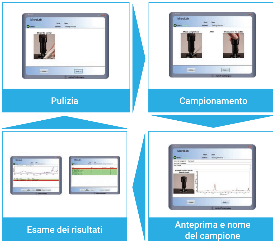
Figura 5. L'interfaccia con istruzioni basate su immagini del software Agilent MicroLab rende più semplice eseguire un'analisi con il sistema FTIR Agilent Cary 630, riducendo le esigenze di formazione. Il software riproduce quello che l'operatore vede quando usa lo strumento. Dopo l'acquisizione dei dati, i risultati vengono visualizzati direttamente in un formato di semplice comprensione, come mostrato nelle Figure 6 e 10. Dopo che l'utilizzatore ha verificato i risultati, il software avvia l'analisi successiva, garantendo un flusso di lavoro di analisi continuo.
