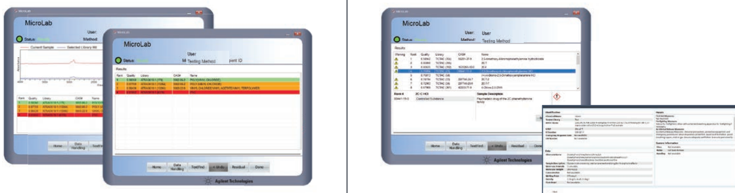
Figure 6. Dans le logiciel Agilent MicroLab, les écrans de résultats des méthodes de recherche dans la bibliothèque sont faciles à comprendre, ce qui permet aux utilisateurs non experts de consulter et d'interpréter les résultats. À gauche : les données des résultats de la bibliothèque s'affichent sous forme de liste uniquement ou de liste plus spectres. À droite : l'affichage facultatif de métadonnées chimiques, y compris les informations de danger et les informations de première intervention sont également disponibles.
