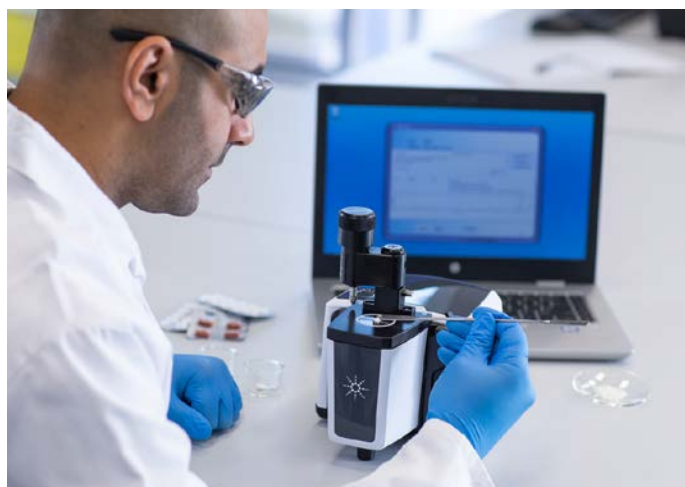
Figure 1. Le FTIR Agilent Cary 630 avec module d'échantillonnage ATR par diamant est utilisé pour établir l'identité de différentes poudres.
