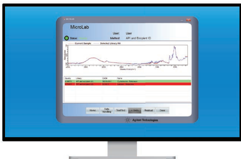
Figure 9. Le logiciel Agilent MicroLab applique le codage des couleurs aux résultats de la recherche dans la bibliothèque. Le codage des couleurs simplifie l'interprétation des résultats et réduit les omissions pouvant causer des erreurs. La capture d'écran présente les résultats de l' \alpha -cyclodextrine en vert indiquant une bonne correspondance avec le spectre de la bibliothèque.
