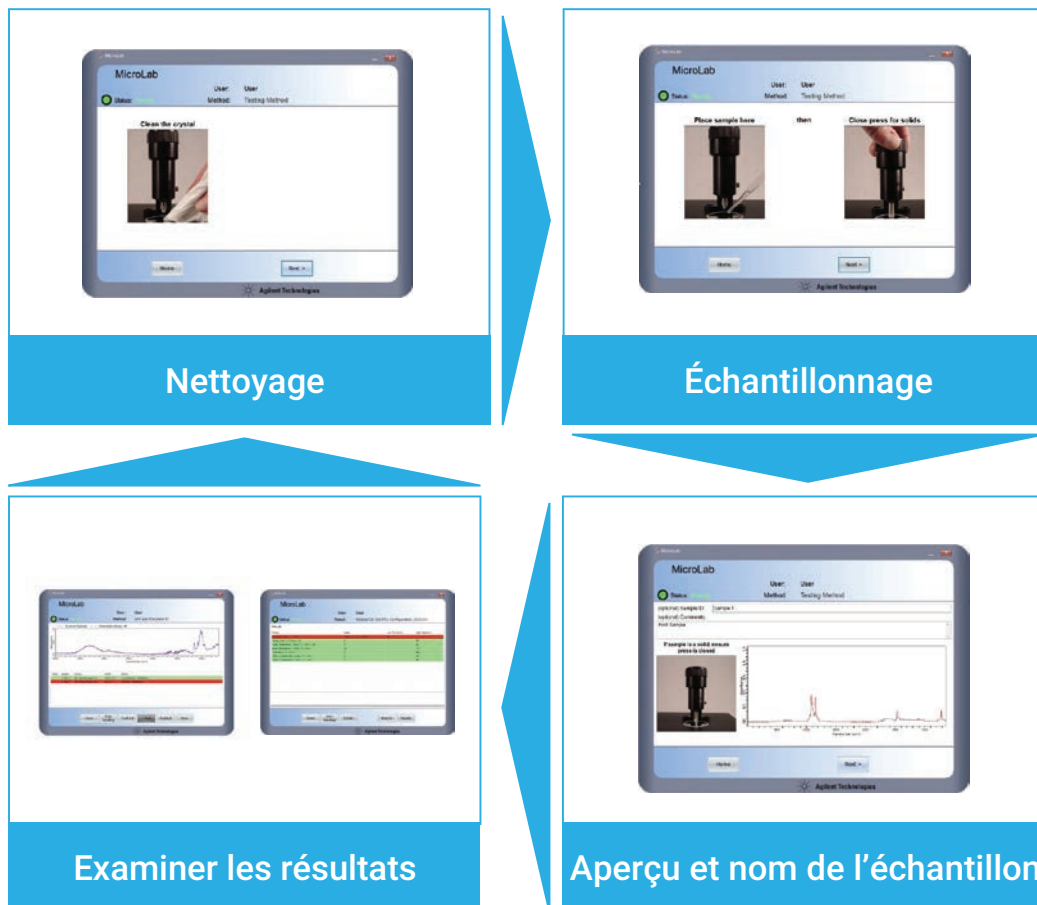
Figure 5. L'interface guidée par images du logiciel Agilent MicroLab simplifie l'exécution d'une analyse avec le FTIR Agilent Cary 630, ce qui réduit les besoins en matière de formation. Le logiciel réplique ce que l'opérateur voit lorsqu'il utilise l'instrument. Après l'acquisition des données, les résultats sont affichés directement dans un format facile à comprendre, comme indiqué dans les Figures 6 et 10. Quand l'utilisateur a vérifié les résultats, le logiciel démarre l'analyse suivante, ce qui garantit une procédure d'analyse continue.
