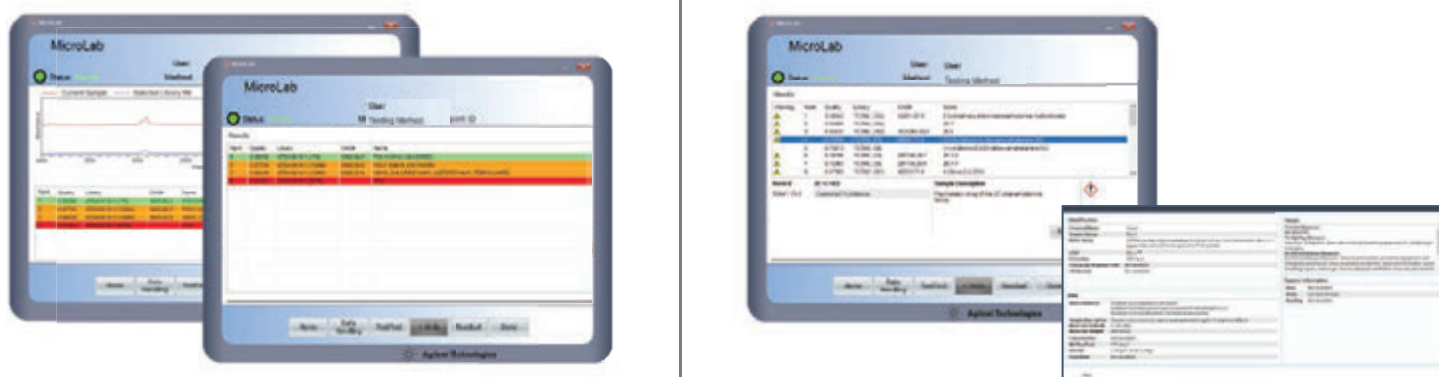
Figura 6. En el software Agilent MicroLab, las pantallas de resultados de los métodos de búsqueda en biblioteca son fáciles de comprender, lo que permite a usuarios sin experiencia revisar e interpretar los resultados. Izquierda: Los datos de coincidencia con biblioteca se muestran como solo lista o como lista más espectros. Derecha: También está disponible la óptima visualización de metadatos químicos, incluida la información sobre riesgos y la información de primera respuesta.
