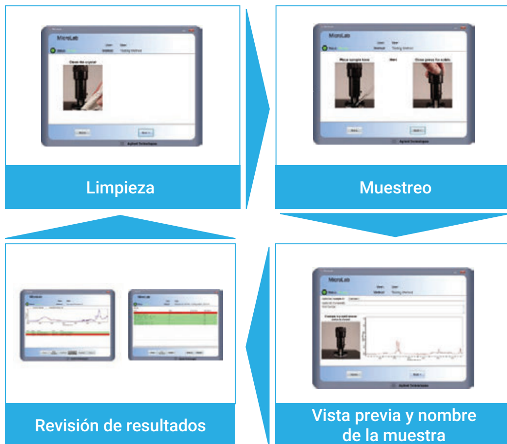
Figura 5. La interfaz del software Agilent MicroLab, con indicaciones mediante imágenes, simplifica la realización de un análisis con el sistema FTIR Agilent Cary 630, reduciendo las necesidades de formación. El software replica lo que ve el operador durante el uso del instrumento. Después de la adquisición de datos, los resultados se visualizan directamente en un formato fácil de comprender, como se muestra en las Figuras 6 y 10. Una vez que el usuario ha comprobado los resultados, el software comienza el siguiente análisis, lo que garantiza un flujo de trabajo analítico continuo.
