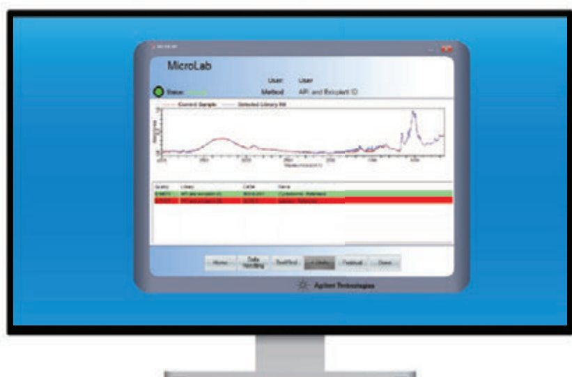
Figura 9. El software Agilent MicroLab aplica la codificación por colores a los resultados de la búsqueda en biblioteca. La codificación por colores simplifica la interpretación de los resultados y reduce los descuidos que pueden provocar errores. La captura de pantalla muestra los resultados de \alpha -ciclodextrina en verde, lo que indica una coincidencia bastante exacta con el espectro de la biblioteca.
