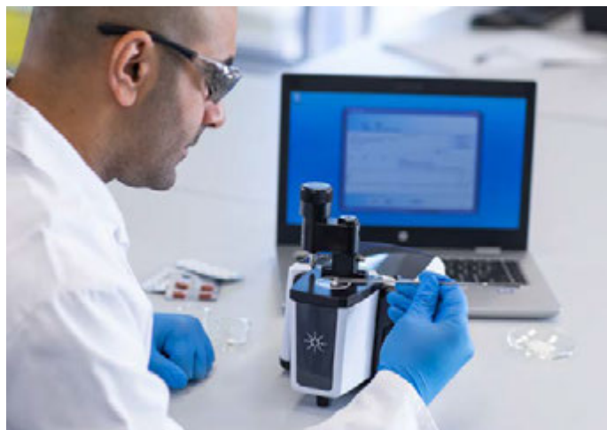
Figura 1. El sistema FTIR Agilent Cary 630 con módulos de muestreo ATR de diamante sirve para establecer la identidad de diferentes polvos.
