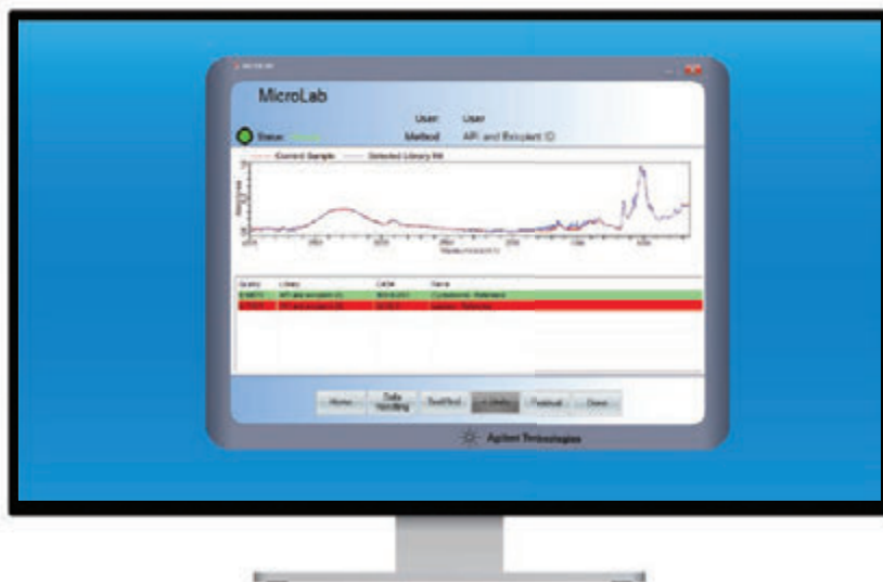
Abbildung 9: Die Agilent MicroLab Software wendet auf die Ergebnisse der Bibliothekssuche eine Farbkodierung an. Die Farbkodierung vereinfacht die Interpretation der Ergebnisse und senkt das Risiko für Flüchtigkeitsfehler. Der Screenshot zeigt die Ergebnisse für \alpha -Cyclodextrin in grün an, was eine gute Übereinstimmung mit dem Bibliotheksspektrum bedeutet.
