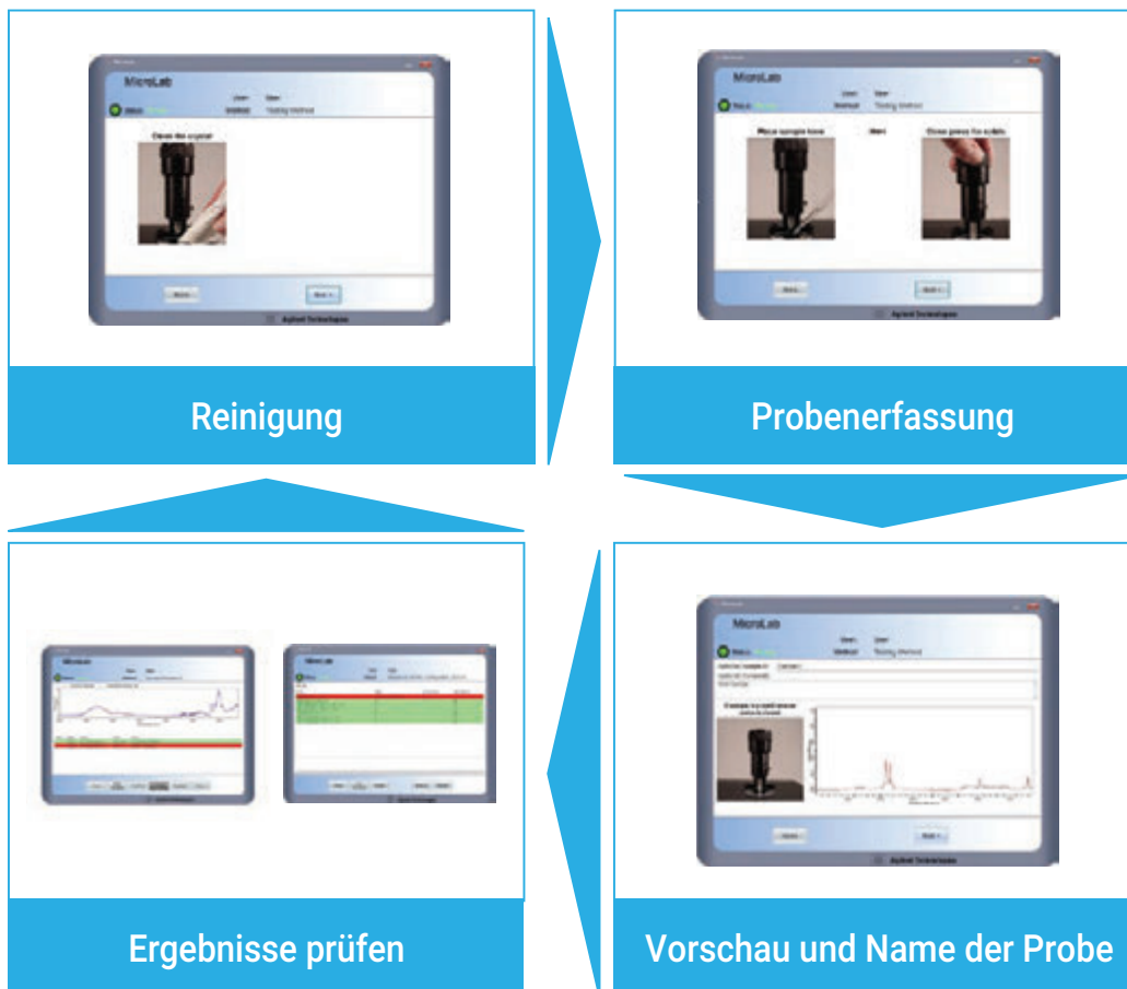
Abbildung 5: Die Bildführung der Agilent MicroLab Softwareschnittstelle vereinfacht die Durchführung einer Analyse mit dem Agilent Cary 630 FTIR und reduziert dadurch Schulungsanforderungen. Die Software zeigt an, was der Benutzer beim Gebrauch des Gerätes sieht. Nach der Datenerfassung werden die Ergebnisse direkt in einem leicht verständlichen Format angezeigt (siehe Abbildung 6 und 10). Nach der Überprüfung der Ergebnisse durch den Benutzer startet die Software die nächste Analyse und stellt so einen kontinuierlichen Arbeitsablauf der Analysen sicher.
