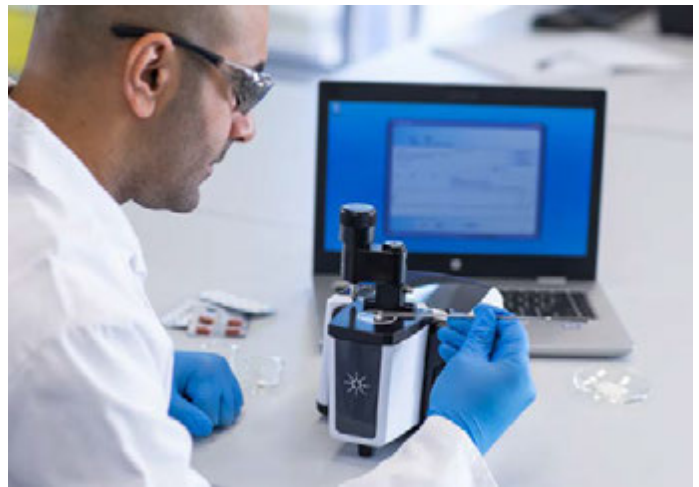
Abbildung 1: Das Agilent Cary 630 FTIR mit Diamant-ATR-Probenzubehörmodul wird verwendet, um die Identität verschiedener Pulver zu bestimmen.
