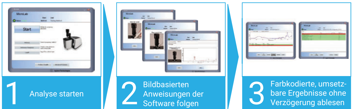
Abbildung 2: Die Generierung von Ergebnissen ist dank der intuitiven Agilent MicroLab Software, die das Agilent Cary 630 FTIR-Spektrometer steuert, einfach. Außerdem reduziert die bildbasierte Software die Schulungsanforderungen und minimiert das Risiko von Benutzerfehlern.
