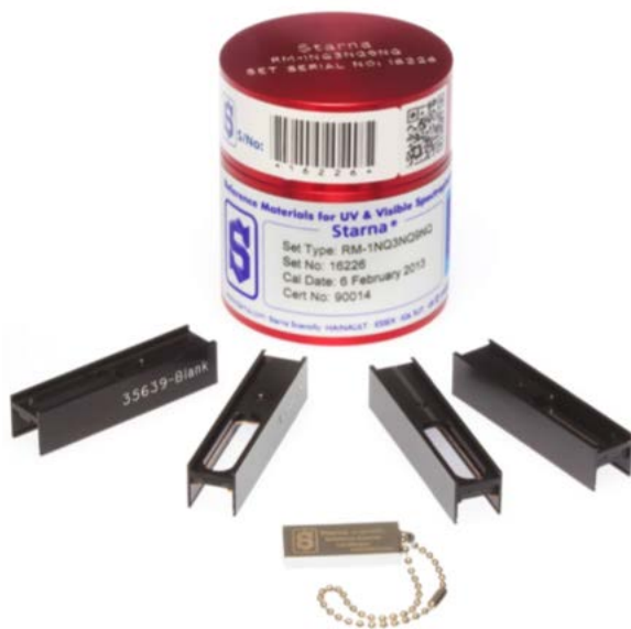
图 2. 用于 Agilent Cary 7000 UMS 的 NIR 光度准确度测试的石英镀金属滤光片。图片经 Starna Scientific Ltd 授权转载
