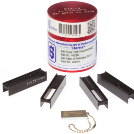
그림 2. Agilent Cary 7000 UMS의 NIR 광도 정확성 테스트에 사용된 메탈 온 퀴츠 필터. Starna Scientific Ltd.의 허가를 받은 사진.
