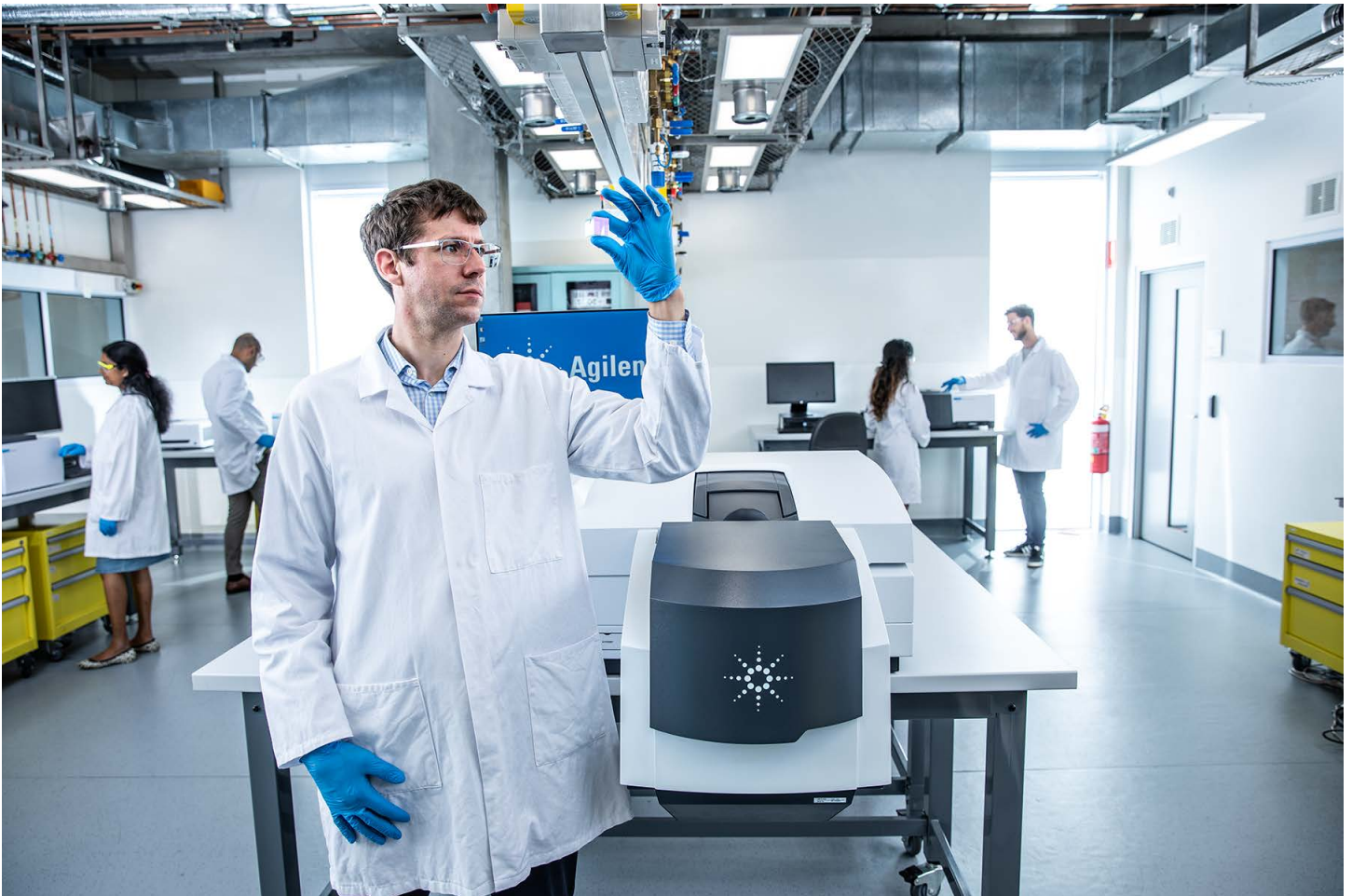
图 1. Agilent Cary 7000 全能型分光光度计 (UMS)。该系统可对立体分光镜等独特的光学样品进行全面表征
