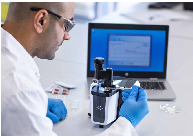
図 1. Agilent Cary 635 FTIR に適切なアタッチメントを取り付けることで、あらゆる分析ニーズに対応できます。ダイヤモンド ATR アタッチメントは、固体、液体、ゲル、粉末の FTIR 分析に最適です。
