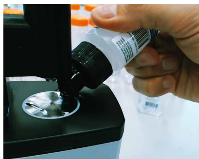
図 9. 希釈なしの消毒剤サンプルを、ATR アタッチメント上に置きます。Agilent MicroLab ソフトウェアでは、ユーザーがクリーニングやサンプリングを含む測定各ステップを踏めるよう、画像ガイド付きのワークフローを採用しています。
