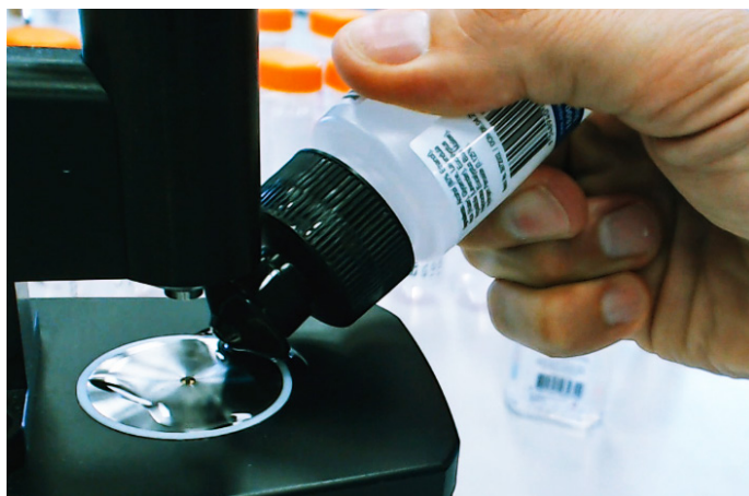
Figura 8. Il campione tal quale di disinfettante per le mani viene depositato sull'accessorio ATR. Il software MicroLab Agilent utilizza flussi di lavoro guidati da immagini per aiutare gli utenti a seguire ogni fase della misurazione, incluse pulizia e campionamento.
