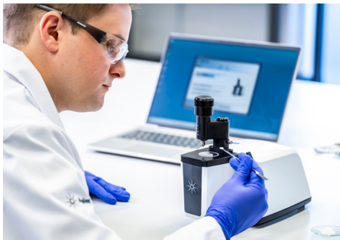
Figura 1. Lo spettrometro FTIR Agilent Cary 635 può essere dotato dei moduli di campionamento idonei a coprire tutte le esigenze analitiche. Il modulo di campionamento ATR in diamante è ideale per l'analisi FTIR di solidi, liquidi, gel e polveri.
